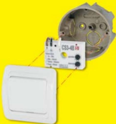
**Nach der Einschaltung des Lichts wird der Ventilator in einem voreingestellten Zeitabstand von 30 s bis 10 Min. eingeschaltet und nach Lichtausschaltung im voreingestellten Zeitabstand 1s bis 20 Stunden ausgeschaltet.**
