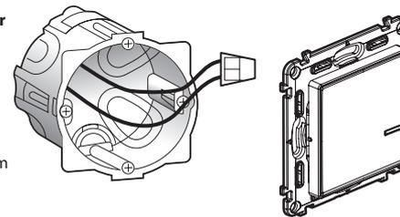
Nutzen Sie eine **Verbindungsklemme**, um die beiden Leitungen zu verbinden.
