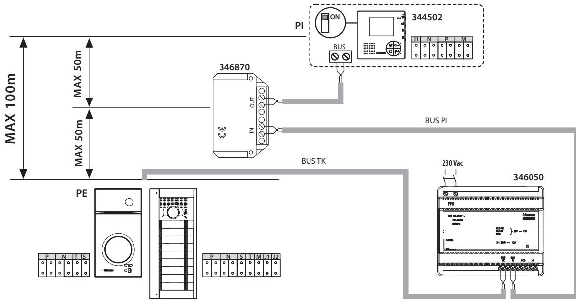
L'art. 346870 consente di realizzare impianti con il sistema 2 fili e cablati con cavi normali (non twistati) aventi sezione  $\geq 0,28 \text{ mm}^2$ , dove la distanza tra PE e PI più lontano supera i 50 m e l'immagine sul video è disturbata o di scarsa qualità.
