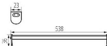
Kanlux MERA LED ist eine Unterschrankleuchte mit integrierten LED's. Die Leuchten sind in Größen von 28 bis 114 cm erhältlich. Außerdem können sie in Reihen (bis zu 5 Leuchten) mithilfe von Kanlux MERA LED PP-Verbindern angeschlossen werden.
