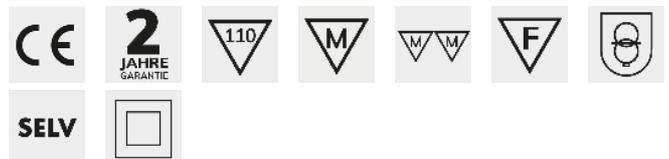
**Besonderheiten:** 12 V/DC LED Netzteil mit MM Kennzeichnung - ideal für direkte Montage auf normal entflammaren Oberflächen wie z.B. Holz. Geschützt gegen Überstrom, Kurzschluss, Übertemperatur Temperaturbereich: -20°C bis +50°C (tc=80°C) Kennzeichen: SELV, MM, F, Schutzklasse 2, IP20
