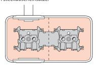
Die Verriegelung mit IP55 des frontseitigen Teils (Deckel) auf der Dose erfolgt durch vier 90°-Drehungen.
