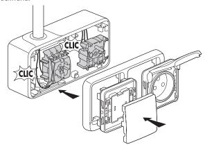
Die Öffnung der Zwei- und Dreifachdosen erleichtert den Zugriff in die Gerätedosen und ermöglicht die Aufnahme der verdrahteten doppelten und dreifachen Steckdoseneinsätze.
